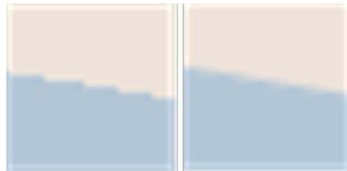
Ejemplo de un borde de polígono sin antialiasing (izquierda) y con antialiasing (derecha)
