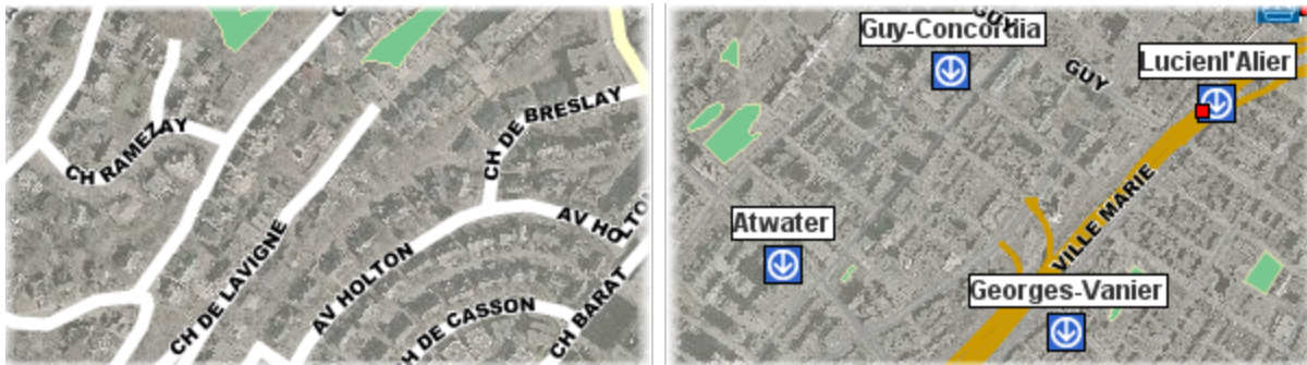
Exemple d'étiquettes en courbe (gauche) et d'étiquettes avec cadre (droite)
